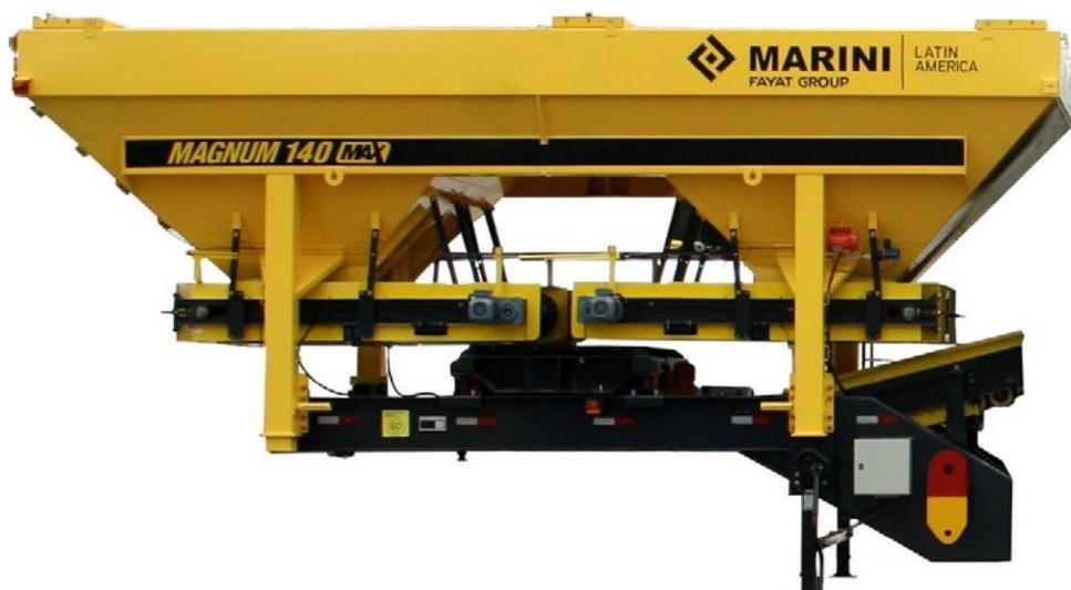
Dosagem individual dos agregados através de células de carga centralizadas, acionadas por motoredutores, controle de velocidade por inversor de frequência com garantia da correta proporção entre agregados.
