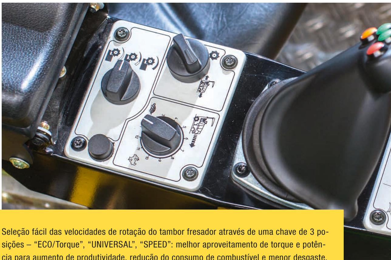
Seleção fácil das velocidades de rotação do tambor fresador através de uma chave de 3 posições – “ECO/Torque”, “UNIVERSAL”, “SPEED”: melhor aproveitamento de torque e potência para aumento de produtividade, redução do consumo de combustível e menor desgaste.
