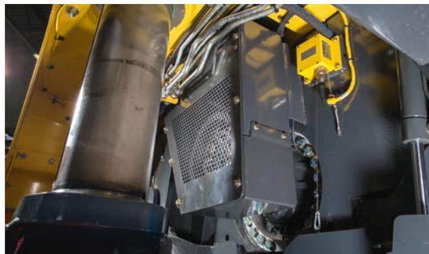
Cilindros hidráulicos de elevação e mecanismo de acionamento com desenho robusto. O grande diâmetro dos cilindros reduz a pressão sobre a superfície de contato e, consequentemente, uma maior vida útil das guias
