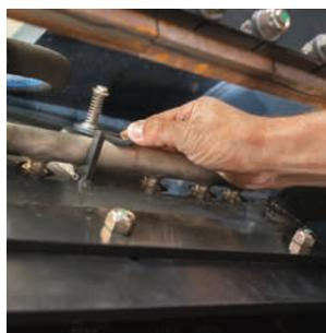
A barra de spray para a refrigeração dos bits pode ser alcançada facilmente, sem necessidade de ferramentas
