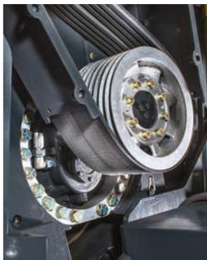
Com arrefecimento externo e filtragem do óleo de transmissão, o redutor de fresagem é especialmente robusto
