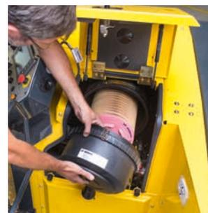
A substituição do filtro de ar também é um processo simples e rápido
