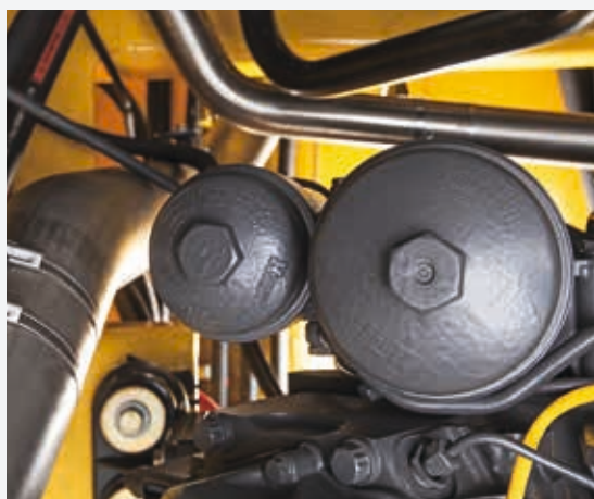
Sistema de filtragem do combustível multifásico (ilustrado-4)
