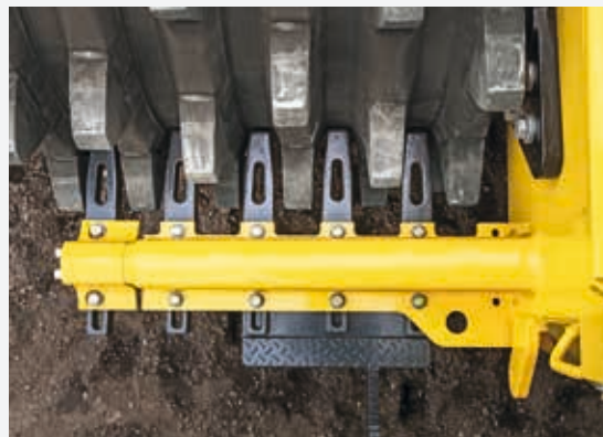
Rodas limpas com raspadores duplos para permitir grau elevado de compactação
