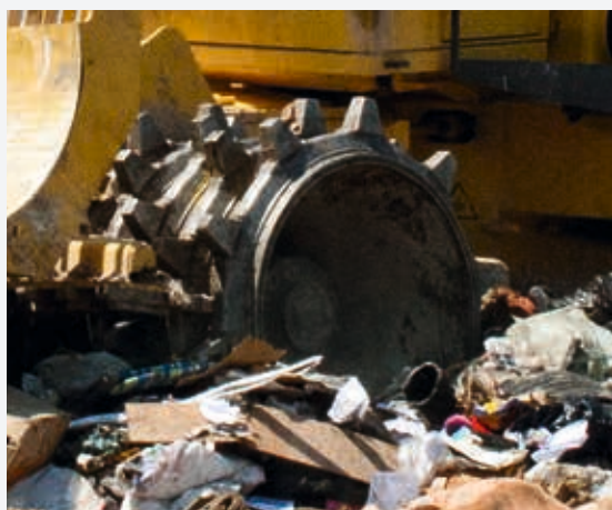
Os raspadores garantem rodas sempre limpas para alto desempenho de compactação
