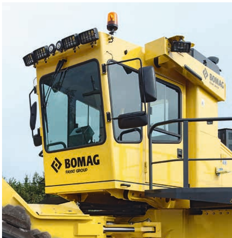
Cabine confortável consistente com as regulamentações de segurança ROPS e FOPS
