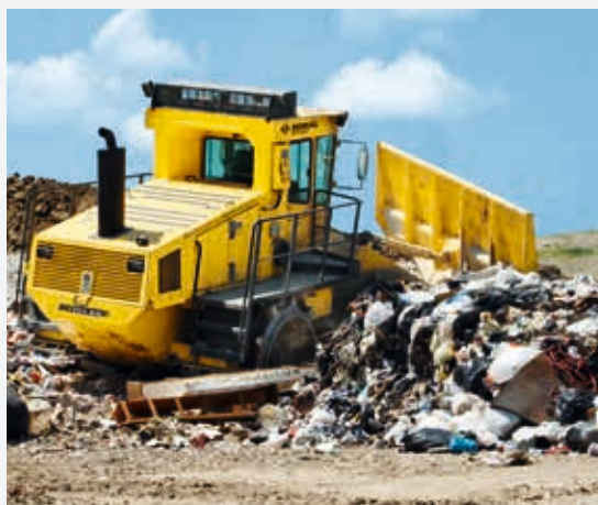
Compactação ótima produzida pelo efeito da articulação pendular que fornece distribuição uniforme da carga nas rodas compactadoras
