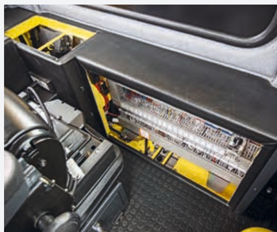
Centro de controle bem protegido na cabine
