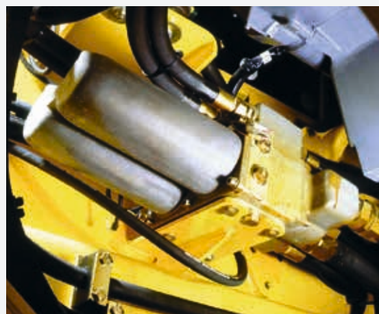
Sistema de filtragem do fluxo de retorno hidráulico controlado eletronicamente
