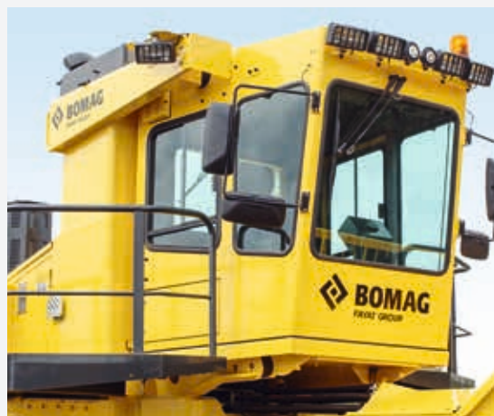
O design da cabine cumpre as regulamentações ROPS e FOPS
