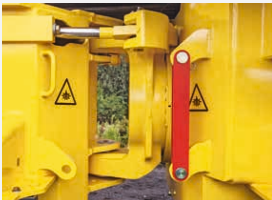
Tração ideal: a articulação pendular fornece contato contínuo com o solo
