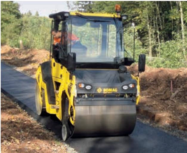
Com suas dimensões compactas, o BOMAG BW 141 AD é especialmente adequado para a construção de caminhos rurais.
